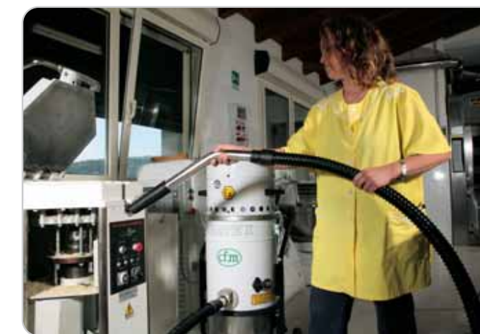
BOULANGERIE: aspiration de la farine arrivée sur le tableau électrique de la machine à trancher.
