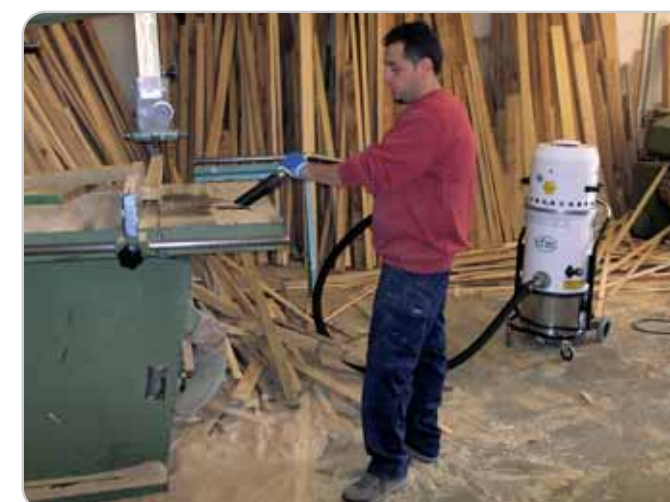
PRODUCTION DE BOIS: aspiration associée à la scie à ruban
